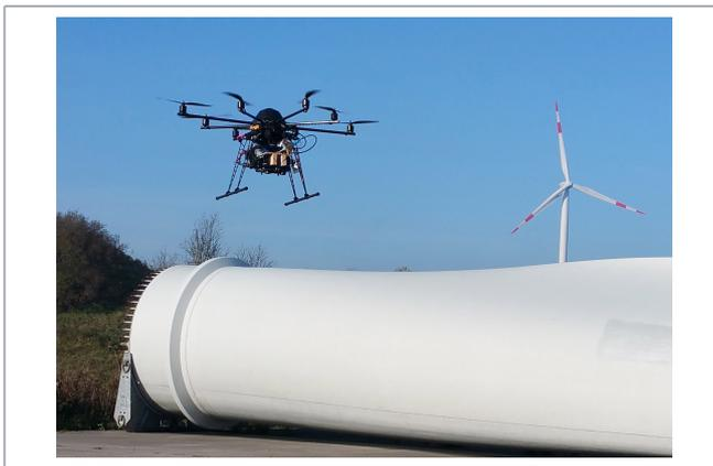
Beispielabbildung: Der „InspektoKopter“-Prototyp bei der Rotorblattbefliegung einer Windenergieanlage (Foto: Netzwerk „InDiWa“, FuE-Projekt „InspektoKopter“).
