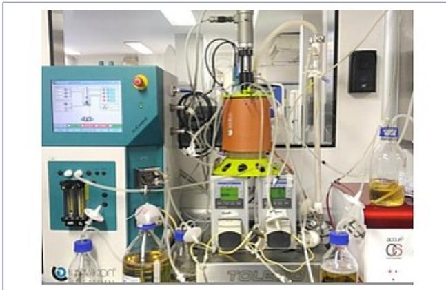
Versuchsaufbau zur Hochzelldichtekultivierung für die Produktion von Zikaviren im 3-Liter-Bioreaktor im Labor des Kooperationspartners, der Abteilung Molekulare Virologie an der Universidade Federal do Rio de Janeiro. © MPI für Dynamik komplexer technischer Systeme Magdeburg / A. Nikolay
